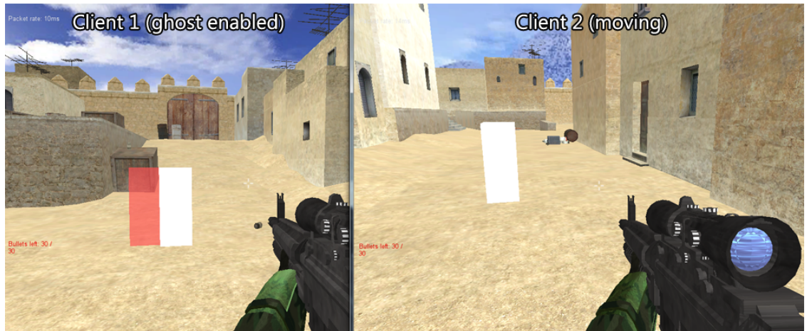
Figuur 8: Weergave van de interpolation ghost: de rode kubus is de effectieve positie die de client heeft binnen gekregen. De witte kubus interpoleert naar de rode kubus.
